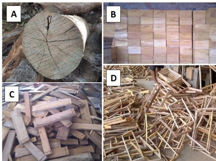
Figura 3. Tora de caixão (A); colmeias prontas para a venda (B); madeira desdobrada para montagem de colmeia (C) e confecção de quadros de ninho de colmeia modelo Langstroth (D), no município de Ribeira do Pombal-BA.
