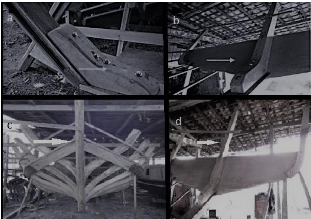
Figura 3. Principais peças estruturais que compõem uma embarcação confeccionada no nordeste paraense: a. coral de proa; b. coral de popa; c. Talha mar e d. painel de popa.
