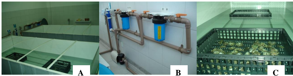
Figura 1. Sistema de depuração de ostras (A). Filtragem da água (B). Ostras em depuração (C).
