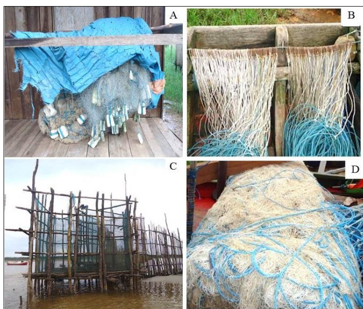
Figura 4. Apetrechos utilizados. Rede de pesca (A); Espinhel (B); Curral (C); Malhadeira (D).
