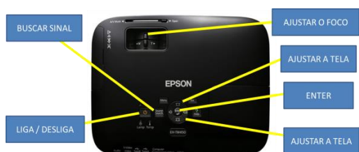
Figura 3 – Funções do projetor multimídia Figura 4 – Interagindo com o projetor multimídia
