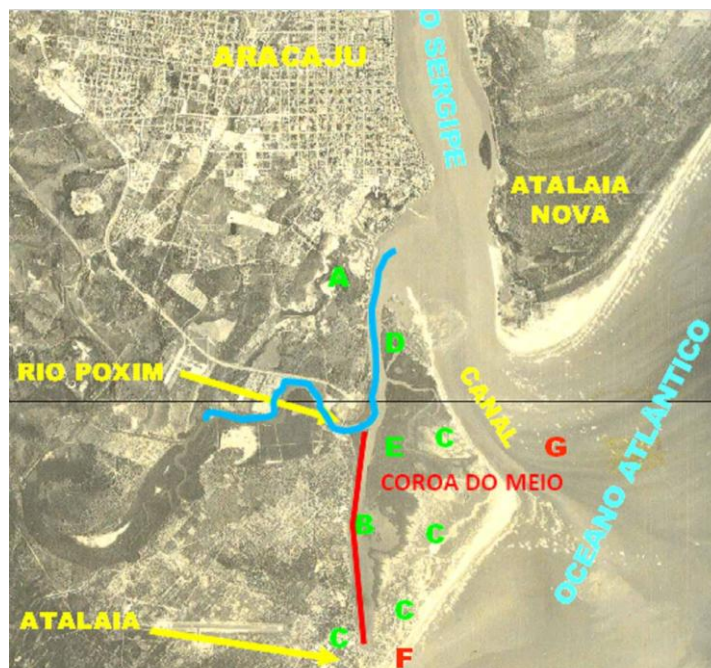
Figura 08. 1971: Sistema Flúvio-Marinho rio Sergipe-rio Poxim. Coroa do Meio em estado natural, antes do projeto de urbanização. Canal ou talvegue junto à margem direita, devido à tendência de migração para o sul, no sentido da antiga foz (F). Foz do rio (G), em 1971, como atualmente. Solos arenosos de restinga (C) e solos lamosos da planície flúvio -marinha ou Maré do Apicum (E), sob mangues alimentados pelos canais de marés. (D) Desnível horizontal entre as extremidades das duas margens da embocadura do Sergipe, sendo a margem direita mais avançada. Letra F marca as adjacências da antiga foz marítima da Barra do Sul, próximo dos atuais Hotel Beira Mar e dos arcos da orla. Embocadura do Tramandaí (A). (B) – Antigo Canal do Sul ou braço morto do rio Sergipe; (C) – Restingas de Atalaia e Coroa do Meio. D – Canais de circulação das marés E – Planície Flúvio-Marinha / Maré do Apicum; F – Local aproximado da antiga foz do rio Sergipe. G – Foz atual do rio Sergipe.
