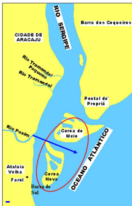
Figura 06. Situação do sistema Poxim-Sergipe em 1894: ampliação das coroas por processos naturais de sedimentação. Consolidação da nova foz do Sergipe, na Barra do Sul, enquanto a do Poxim ainda se fazia pela Barra da Barreta (seta), situada entre as duas coroas. Fonte: Base cartográfica BRASIL.Ministério da Marinha, 1894. Desenho: Wanderley, 2006.
