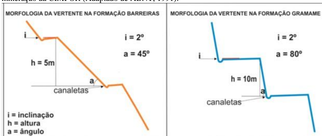
Figura 5 – Corte esquemático das vertentes finais em solos e rochas propostos para as áreas de mineração da CIMPOR (Adaptado de ABNT, 1991).
